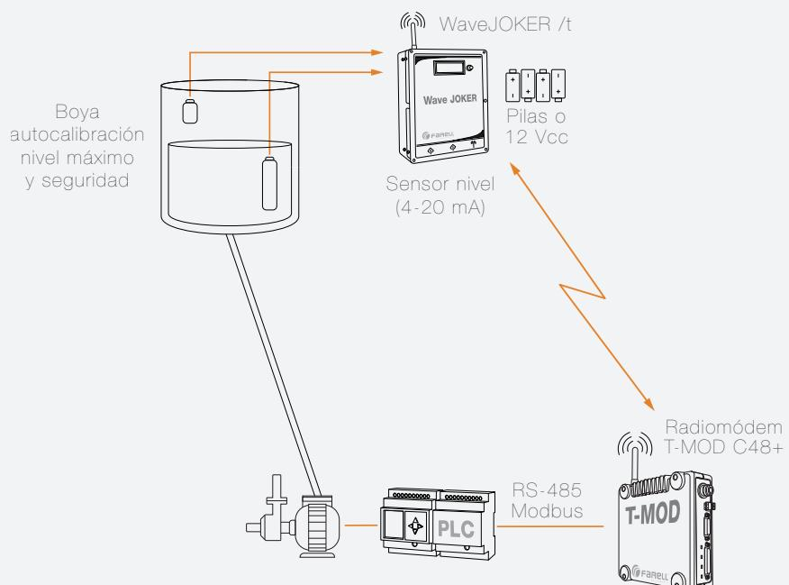
La unidad WaveJOKER /t transmite de manera periódica y también si hay variaciones de las señales de entrada. El protocolo empleado es Modbus RTU. El Modo Maestro permite alimentar la unidad WaveJOKER /t a pilas, con una autonomía superior a 3 años.
