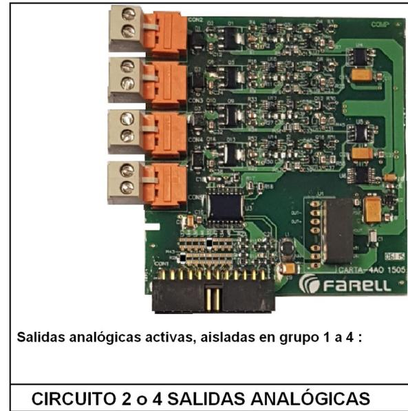
Para ampliaciones de E/S se añadirán las tarjetas electrónicas adecuadas. Antes de insertar una tarjeta se desconectará la alimentación de la unidad y se esperará un mínimo de 1 minuto.
