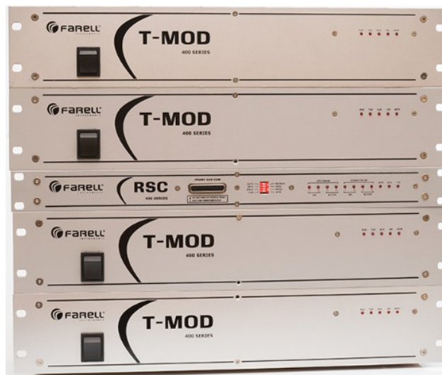
Unidad T-MOD 400 repetidor Back-To-Back en modelo rack 19” con unidad RSC controladora de redundancia y diversidad
